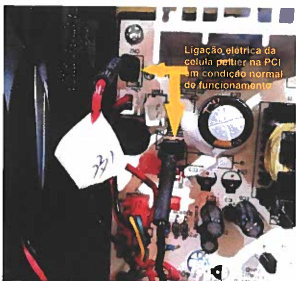
Foto 1 - Condição normal da ligação da célula Peltier na PCI da chopeira
